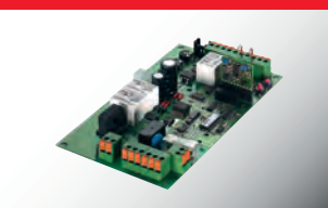
Hoogwaardige Duitse elektronische besturing met permanente automatische kracht meting en controle. Automatische diagnose meldingen via led-uitlezing. Inplugmogelijkheid van AZ-, GT-, EI- Module
