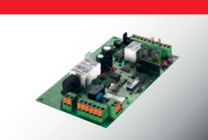
Commande électronique de fabrication allemande avec mesure de force automatique permanente et diagnostic de contrôle par led. Plusieurs modules sont disponibles, AZ-, GT-, EI-Module.
